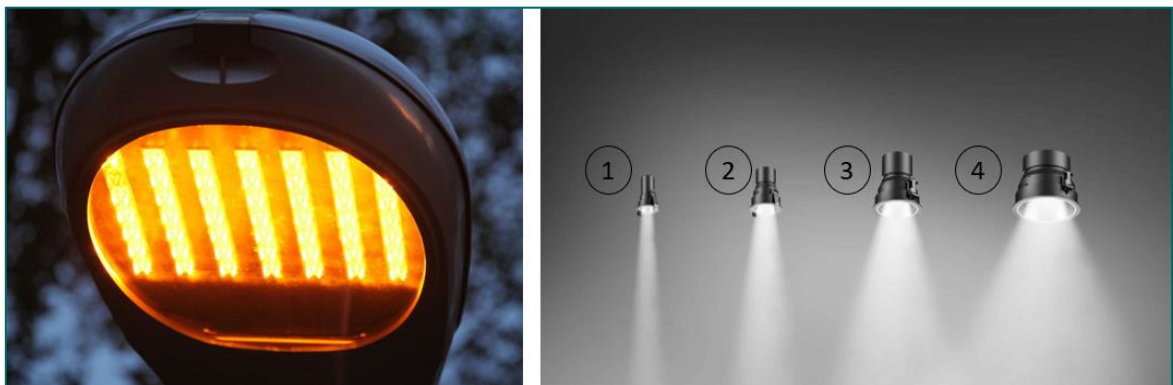
Figuur 3.5 Links: Amberkleurig licht. Rechts: Een geconvergeerde lichtbundel (1) ten opzichte van gedivergeerd licht (2, 3 en 4).
