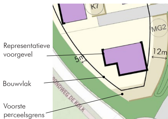
De representatieve voorgevel, het bouwvlak en de voorste perceelsgrens weergegeven met afmetingen
